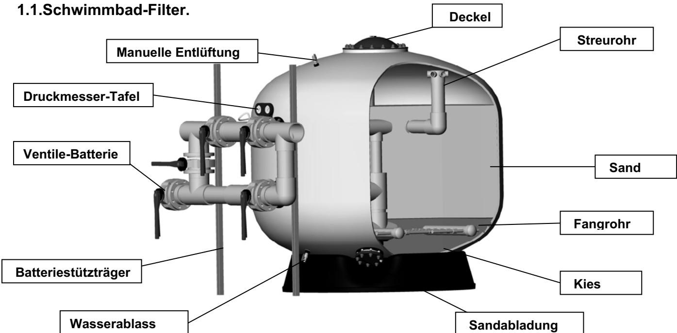
Die Filter sind zweifellos das wichtigste Zubehör zur Wasserfilterung. Und deren Hauptziel ist es, Schweb- und Sinkstoffe zu beseitigen und das Wasser zu klären.
