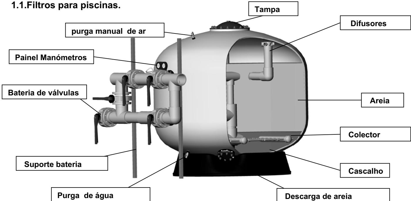
Os filtros são sem dúvida os acessórios mais importantes para a filtração da água. E o seu uso tem por objectivo eliminar as matérias em suspensão e clarificar a água.
