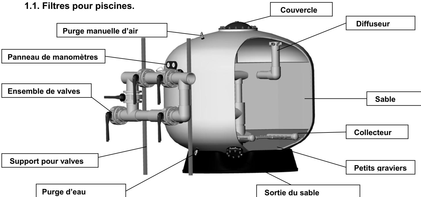
Les filtres constituent sans aucun doute les accessoires les plus importants pour le filtrage de l'eau. Leur fonction consiste à éliminer les matières en suspension et à clarifier l'eau.
