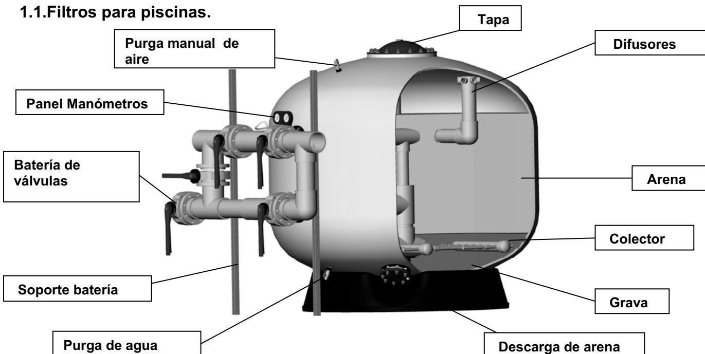
Los filtros son sin duda los accesorios más importantes para la filtración del agua. Y su uso tiene por objeto eliminar las materias en suspensión y clarificar el agua.
