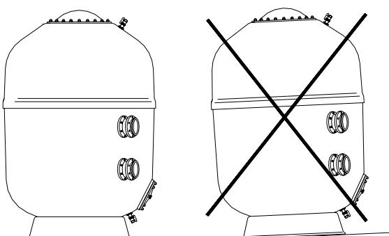
**Installer le filtre sur une surface parfaitement horizontale**
