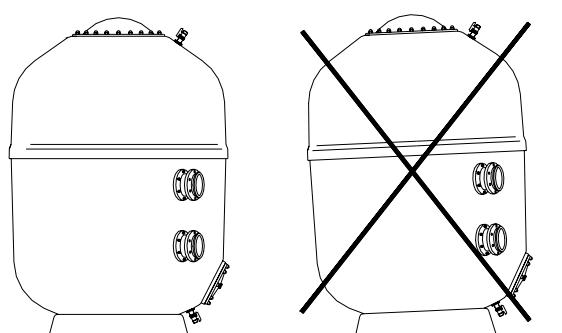
**Der Filter ist auf einer ebenen Fläche sowie in absolut waagerechter Lage aufzustellen**
